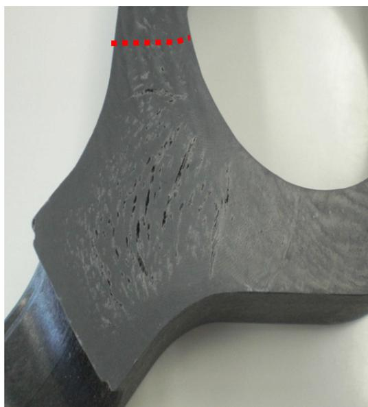
左図は PA66-GF50%の材料における肉厚成形品を肉厚中央部で切削した画像です。赤点線で示した部分にウェルドラインが発生していますが、全域にわたり白く変色した部位が存在し、その中央部にクラック状のボイドが発生しています。白く変色した部分は微細なボイドであり、中央部にあるクラックは微細なボイドが中央部に集中していることからボイド同士が繋がりクラック形状に発展したものです。
