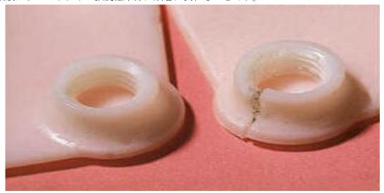
上記に示すように製品端部に配置されたネジ部においてウェルドライン部に破壊起点が 現れます。
